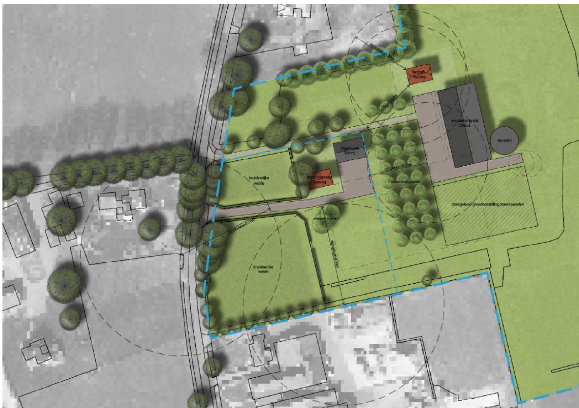
Verplaatsen schuur en realisatie mestsilos
