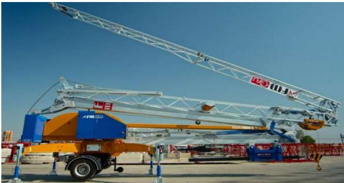
Figuur 8 Voorbeeld middelzware, mobiele kraan. Geschikt voor aanreiken balken, panelen etc.
